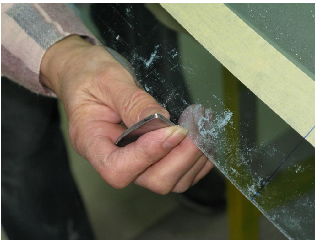
Fig. 25: Scrape the edge
